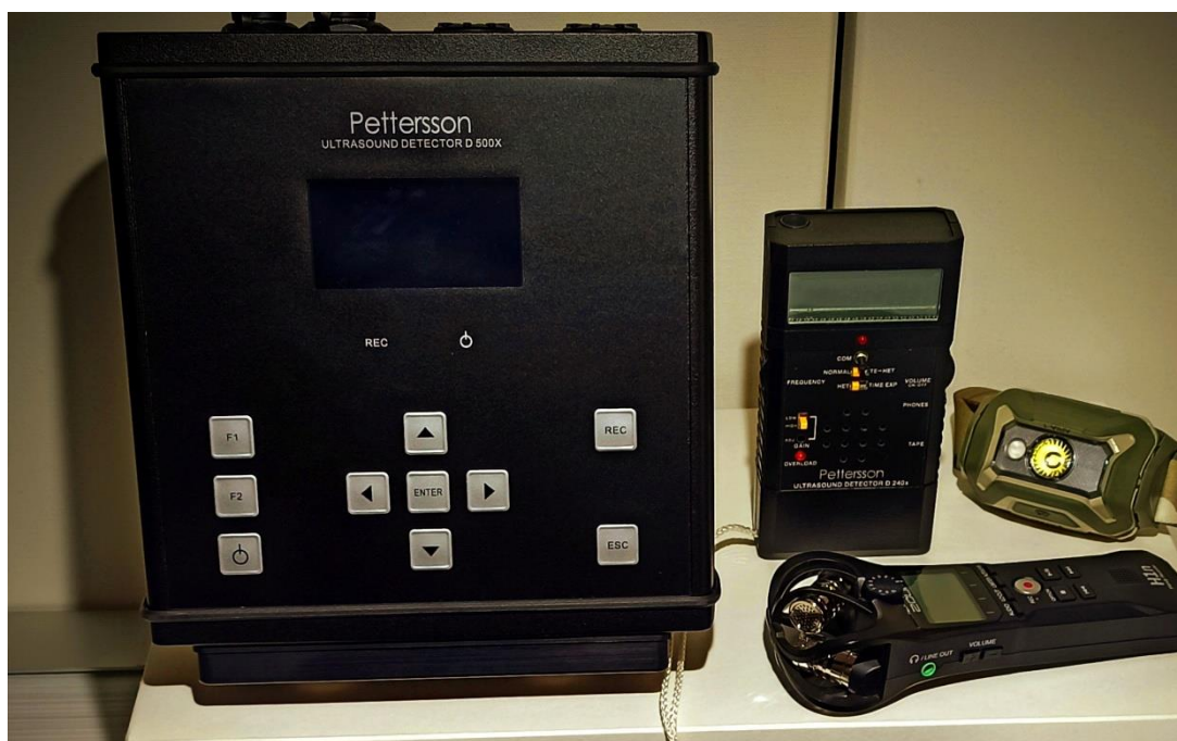
Figura 8: Attrezzatura utilizzata per il monitoraggio dei chirotteri. Da destra verso sinistra: Rilevatore a eterodina ed espansione temporale D 240 X (x10 e x20 selezionabile). Bat detector D 500X per la registrazione prolungata in campo degli ultrasuoni. Registratore multitraccia collegato al D 240X.
